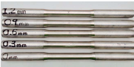
圖 5. 不同凹痕深度 6061-T6 鋁合金管之照片。
