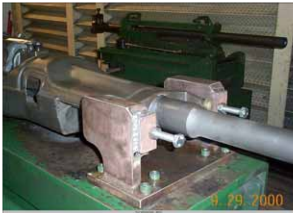
圖 2. 20 公厘機砲後座力量測導軌裝置。
