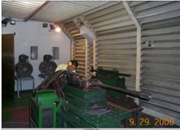
圖 1. 20 公厘機砲後座力量測測試台。
