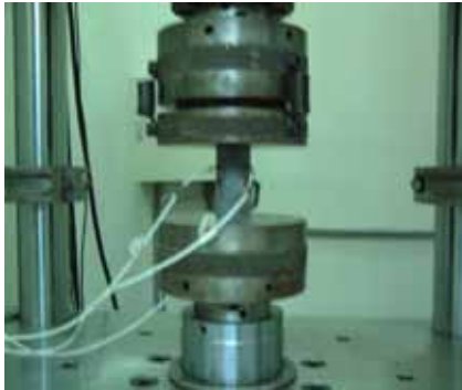
圖 2. 試體進行單軸抗壓試驗。(MTS-100 噸)
