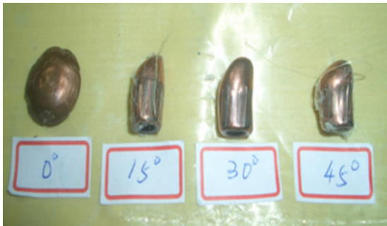
(A) UD直向布各角度射擊後之變形彈頭
