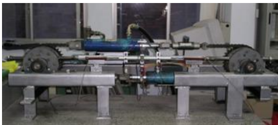
圖 1. 彎管實驗機之(a)示意圖及(b)照片
