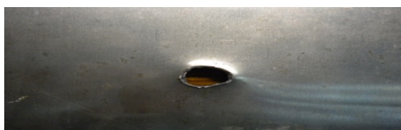
(e)2A30S9.3D30S1A第三層靶板(背彈面)受實彈撞擊破壞狀況。
