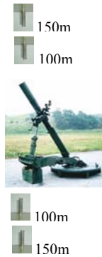
圖11. 大口徑武器射擊麥克風位置圖。
