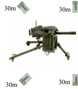
圖14. 小口徑武器射擊麥克風位於左右後方位置圖。
