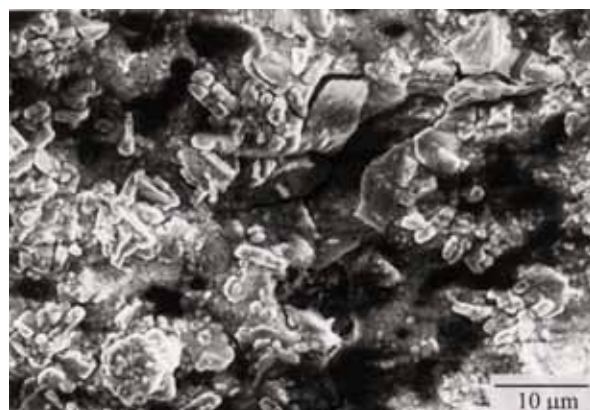
圖 7. 鍍 Al-7wt.%Si 並經預氧化處理之 310 不鏽鋼，於 800^\circ\text{C} ， \text{Ps}_2 = 10^{-2} atm.腐蝕 181.7 小時後的表面形態圖。
