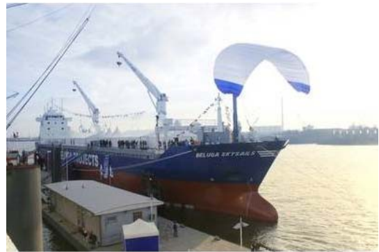
圖 7. 天帆拖曳大型貨櫃輪 [21]。
