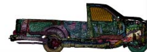
圖 29. 貨卡車架剖面在 56km/hr 之變化—70 毫秒。
