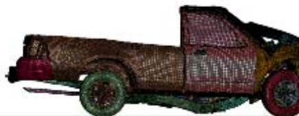
圖 16. 貨卡車架結構在 48km/hr 之變化—110 毫秒。
