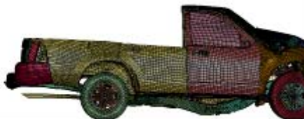
圖 21. 貨卡車架剖面在 52km/hr 之變化—70 毫秒。
