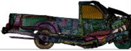
圖 25. 貨卡車架剖面在 52km/hr 之變化—110 毫秒。
