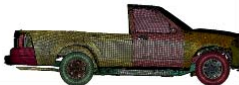
圖 18. 貨卡車架結構在 52km/hr 之變化—50 毫秒。
