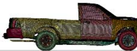
圖 20. 貨卡車架結構在 52km/hr 之變化—70 毫秒。
