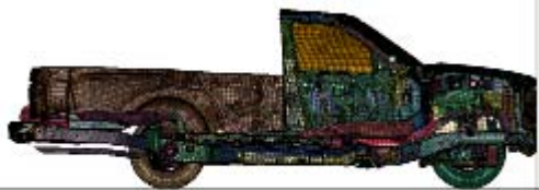
圖 11. 貨卡車架剖面在 48km/hr 之變化—50 毫秒。
