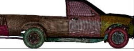
圖 26. 貨卡車架結構在 56km/hr 之變化—50 毫秒。
