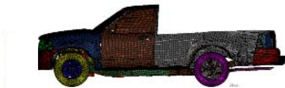
圖 3. 貨卡車車體有限元素模型-側視圖。
