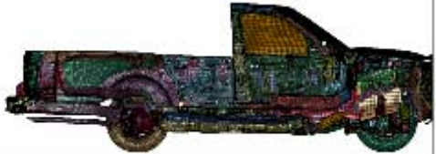
圖 27. 貨卡車架剖面在 56km/hr 之變化—50 毫秒。
