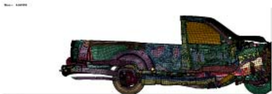
圖 37. 貨卡車架剖面在 60km/hr 之變化—70 毫秒。
