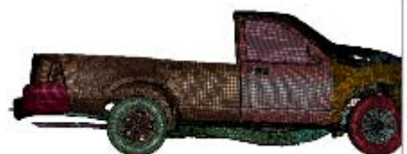
圖 14. 貨卡車架結構在 48km/hr 之變化—90 毫秒。
