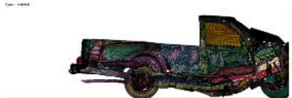
圖 31. 貨卡車架剖面在 56km/hr 之變化—90 毫秒。
