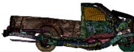
圖 17. 貨卡車架剖面在 48km/hr 之變化—110 毫秒。
