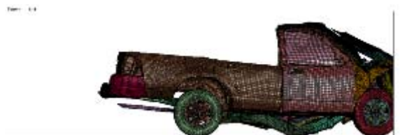
圖 32. 貨卡車架結構在 56km/hr 之變化—110 毫秒。
