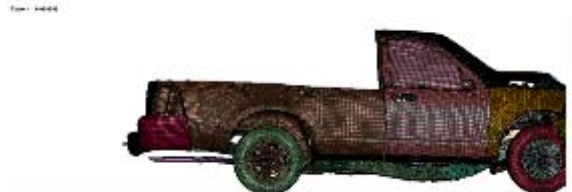
圖 36. 貨卡車架結構在 60km/hr 之變化—70 毫秒。
