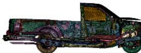
圖 21. 貨卡車架剖面在 52km/hr 之變化—70 毫秒。
