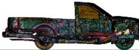
圖 19. 貨卡車架剖面在 52km/hr 之變化—50 毫秒。
