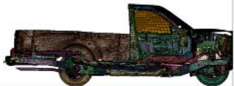
圖 13. 貨卡車架剖面在 48km/hr 之變化—70 毫秒。
