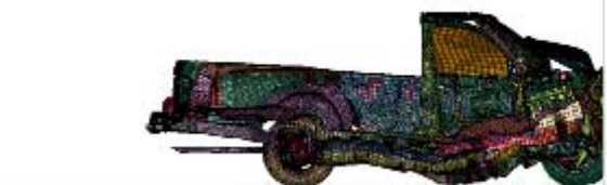
圖 39. 貨卡車架剖面在 60km/hr 之變化—90 毫秒。
