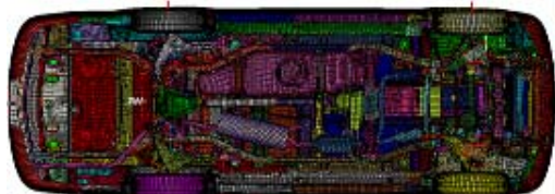
圖 4. 貨卡車車體有限元素模型-下視圖。
