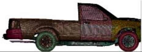
圖 12. 貨卡車架結構在 48km/hr 之變化—70 毫秒。
