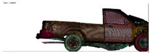
圖 30. 貨卡車架結構在 56km/hr 之變化—90 毫秒。
