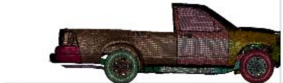
圖 34. 貨卡車架結構在 60km/hr 之變化—50 毫秒。
