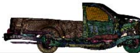
圖 15. 貨卡車架剖面在 48km/hr 之變化—90 毫秒。
