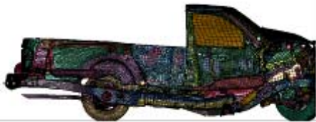
圖 23. 貨卡車架剖面在 52km/hr 之變化—90 毫秒。
