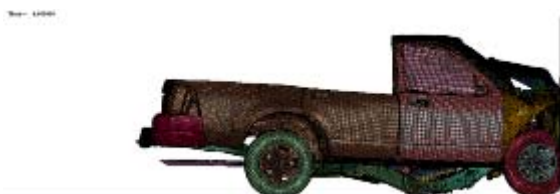
圖 38. 貨卡車架結構在 60km/hr 之變化—90 毫秒。
