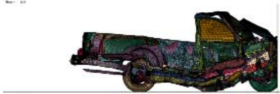
圖 33. 貨卡車架剖面在 56km/hr 之變化—110 毫秒。
