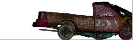
圖 40. 貨卡車架結構在 60km/hr 之變化—110 毫秒。
