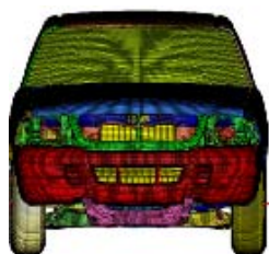
圖 5. 貨卡車車體有限元素模型-正視圖。
