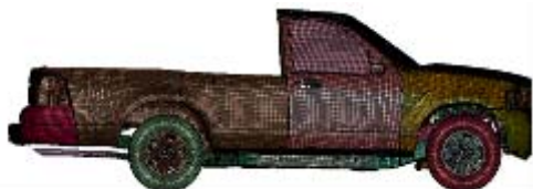
圖 10. 貨卡車架結構在 48km/hr 之變化—50 毫秒。
