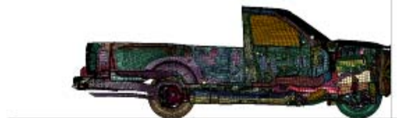
圖 35. 貨卡車架剖面在 60km/hr 之變化—50 毫秒。
