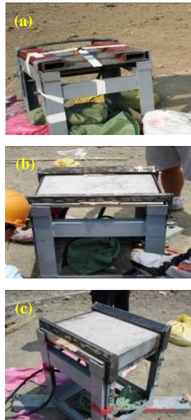
圖 3. 不同厚度之不鏽鋼板設置情形：(a)1 公分；(b) 2 公分；(c)5 公分
