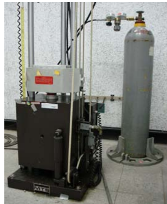
圖 2. 自由落體式衝擊機
