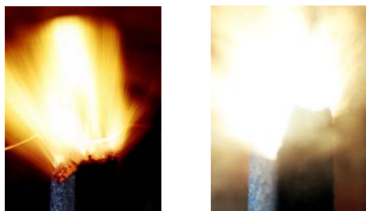
圖 11. 配方 009 GAP/CL20/AP 含 0.5% Phthalocyanine Copper 燃燒現象：(a) 5 kgf/cm 2 ；(b) 30 kgf/cm 2
