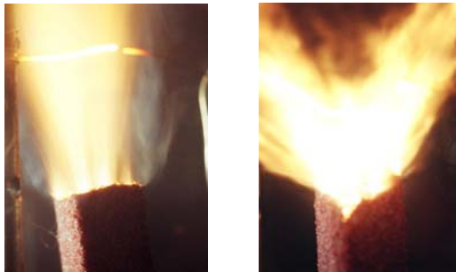
圖6. 配方004 GAP/CL20含0.5% Fe 2 O 3 燃燒現象： (a) 5 kgf/cm 2 ；(b) 30 kgf/cm 2 。
