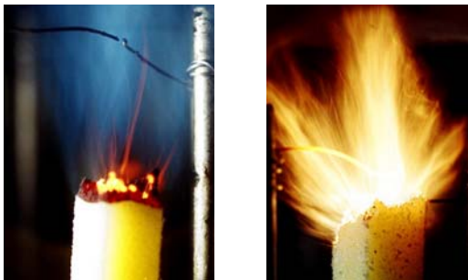
圖7. 配方006 GAP/CL20含0.5% Butacene 燃燒現象： (a) 5 kgf/cm 2 ；(b) 30 kgf/cm 2
