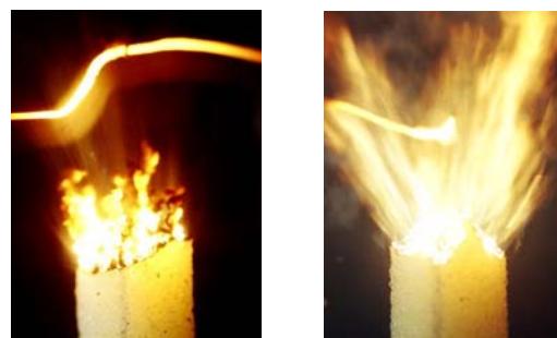
(a) (b) 圖4. 配方003 GAP/CL20/AP(225 \mu m)燃燒現象： (a) 5 kgf/cm 2 ；(b) 30 kgf/cm 2
