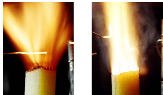
圖10. 配方007 GAP/CL20/AP含0.5% Butacene 燃燒現象： (a) 5 kgf/cm 2 ；(b) 30 kgf/cm 2
